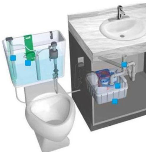
Figura 8. Sistema de desvío para reutilizar el agua proveniente del lavabo
