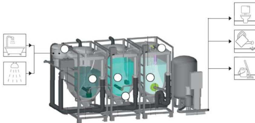
Figura 9. Sistema electromecánico para el tratamiento de aguas grises
